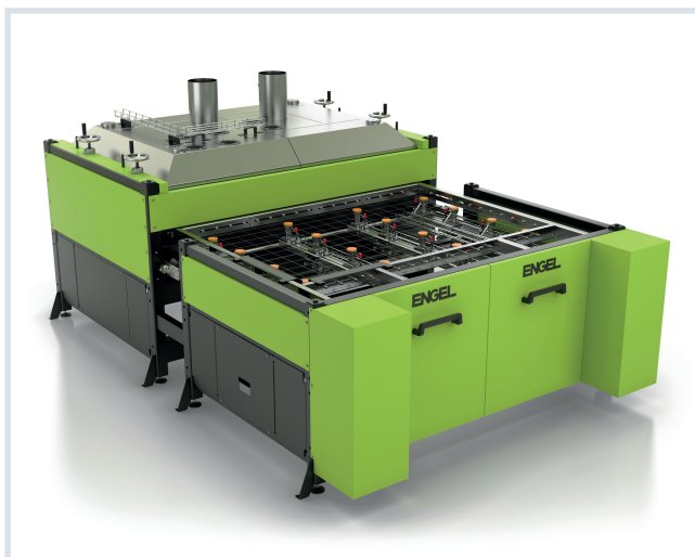
Bild 2. Horizontaler beidseitiger IR-Ofen mit 1100 x 600 mm Nutzfläche. Die Strahler werden in Gruppen zusammengefasst, um sie anhand einer spezifischen Temperaturmessung zu regeln © Engel
