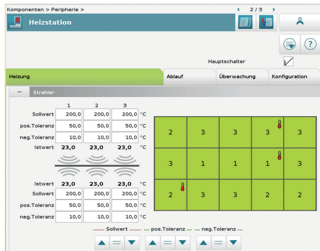
Bild 2. Horizontaler beidseitiger IR-Ofen mit 1100 x 600 mm Nutzfläche. Die Strahler werden in Gruppen zusammengefasst, um sie anhand einer spezifischen Temperaturmessung zu regeln © Engel
